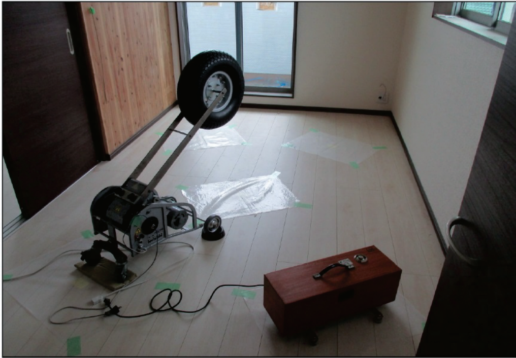
(a)音源室：3階 A 洋室（衝撃源設置状況）
