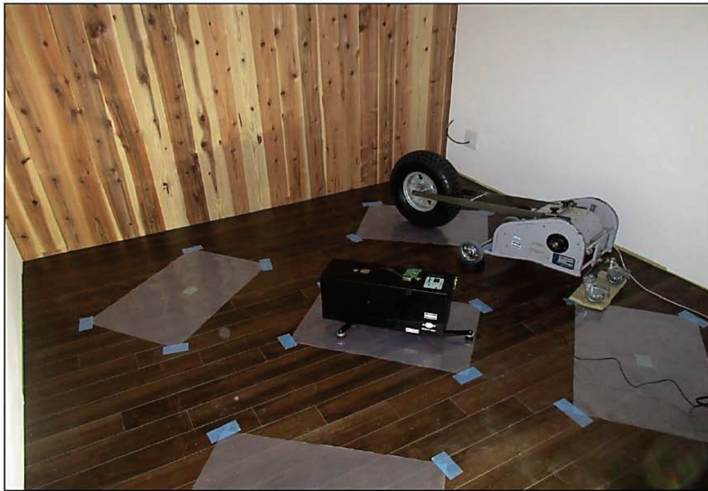
(a)音源室：2階 201 居室2（衝撃源設置状況）
