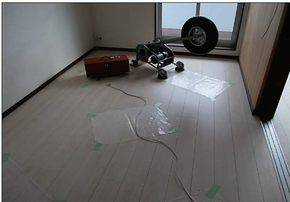
(a)音源室：3階 B 洋室（衝撃源設置状況）
