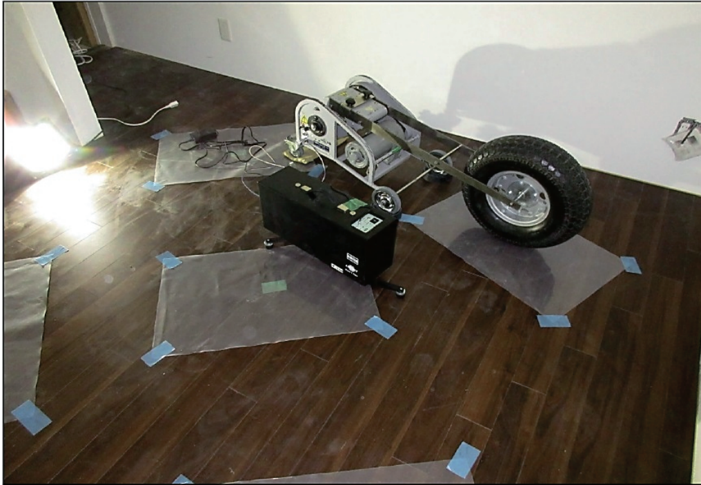
(a)音源室：2階 203 居室2 (衝撃源設置状況)
