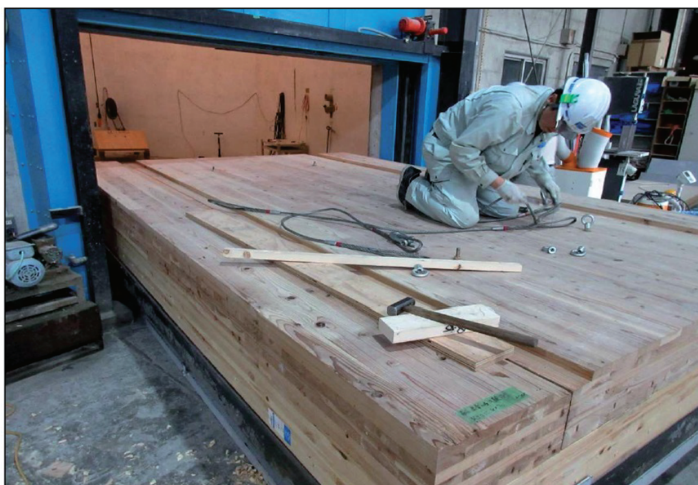
(b) 床CLTパネルの設置
