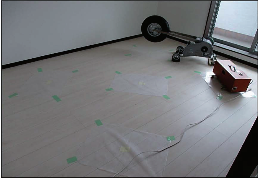
(a)音源室：3階 A LDK (衝撃源設置状況)
